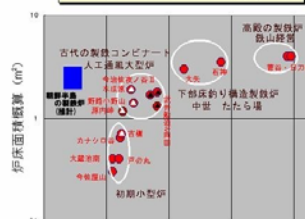
たたら製鉄 箱型炉の大きさ変遷 概算
