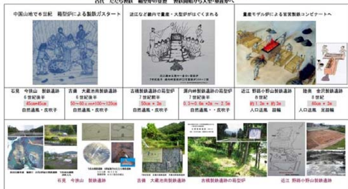
古代 たたら製鉄 箱型炉の発展 製鉄開始から大型・箱型炉へ
