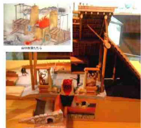
箱型たたら炉とその地下構造
