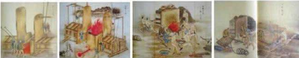
「先大津阿川山砂鉄洗取図」より 鉄生産 (本床づくり たたら製鉄 大鍛冶 針金製造)
