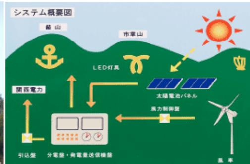
風力太陽光発電システム概要図
