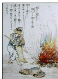
a. 地炉加熱による酸化銅成分と 銅スラグとの分離 江戸期の銅製錬技術(銅子銅山)
