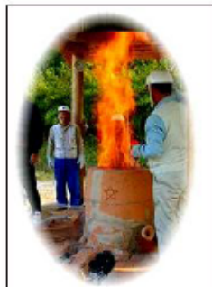
安芸門前山による還元製錬 原料鉱石は自然銅・硫化銅系銅鉱石 古代 銅製錬 還元実験の図(長登)
