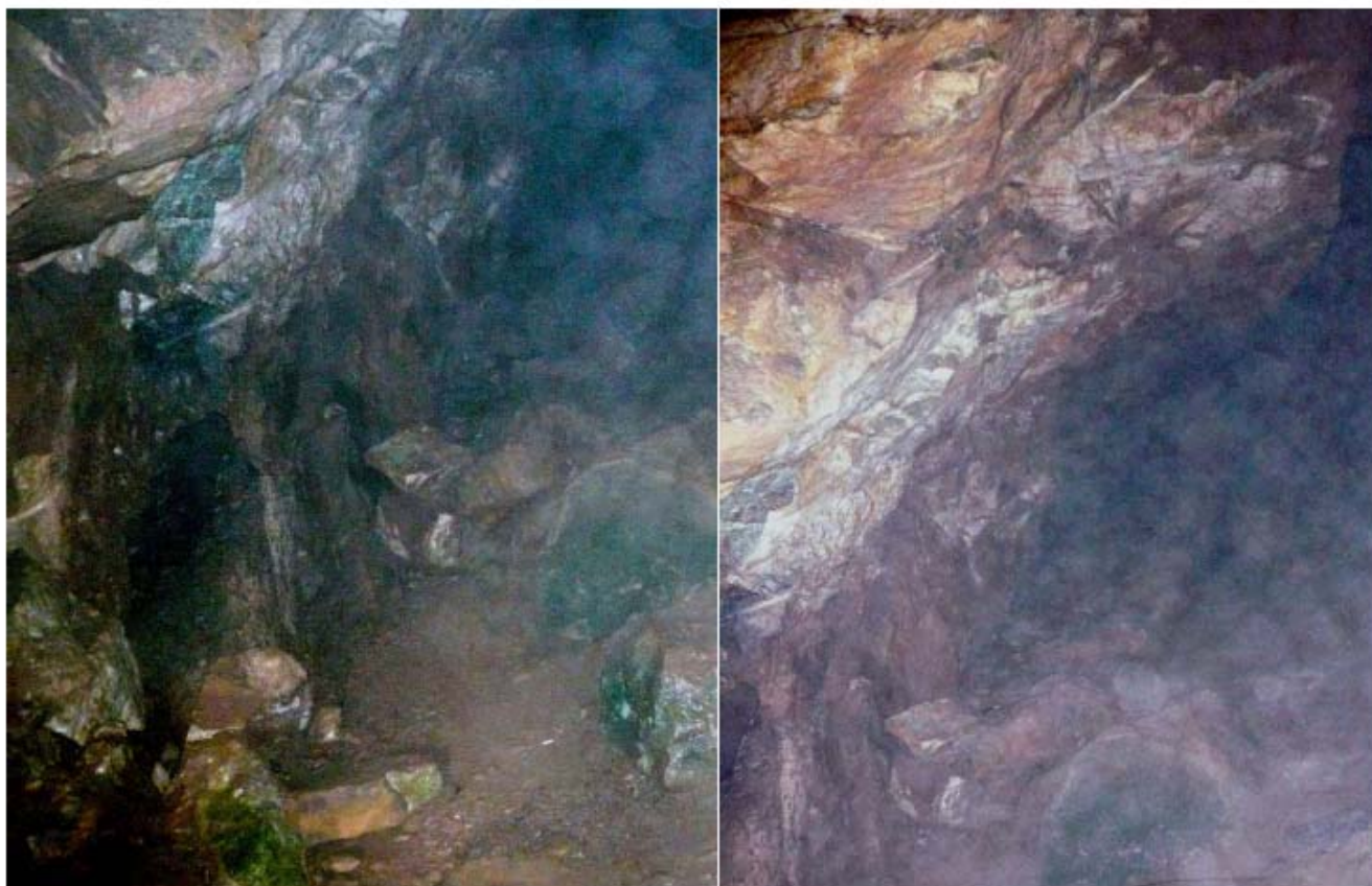
滝ノ下大切山 4 号坑 内部の坑道の壁に見られる銅鉱脈
