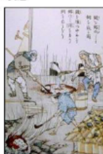
⇒ 硫化銅成分溶解と酸化銅「灰吹き」 回の中中央に空気吹き付け羽口が見える 江戸期の銅製錬技術（別子銅山）
