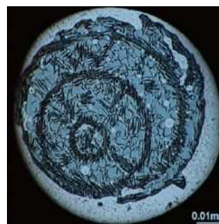
二相分離した銅・鉄急冷アトマイズ粉
