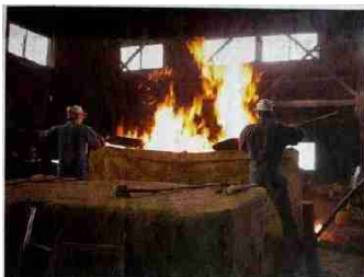
たたら炉操業 砂鉄を入れる
