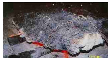
たたら製鉄で造って 炉だした「ケラ」 このケラの中心部に「玉鋼」周辺部は銑鉄
