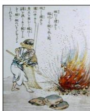
a. 地炉加熱による酸化銅成分と 銅スラグとの分離
