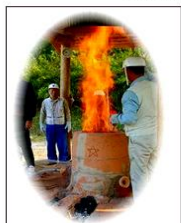
室型円筒炉による還元製錬 原料鉱石は自然銅・酸化銅系銅鉱石 古代 銅製錬 還元実験の図 (長登)
