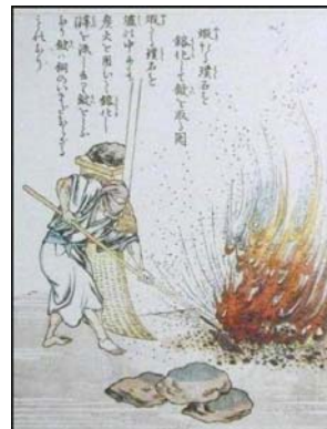
焼いた鉱石を火床で溶融し、 鉄分と硫黄を飛ばして 硫化銅が主成分のカワにする 別子銅山「鼓銅図録」より
