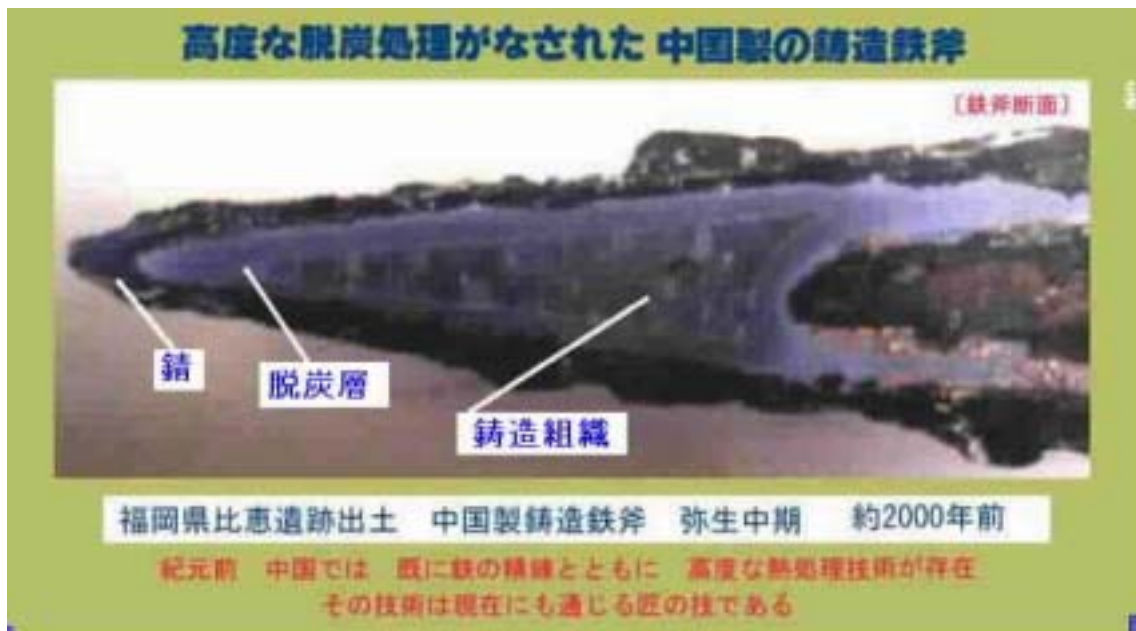
高度な熱処理による脱炭表面処理がなされた中国製の古代 铸造鉄斧
