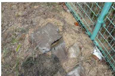
顔を出している石を金鎚で叩くとスパッと割れ、色黒々のリバーパターン状の平坦な破面が出た
