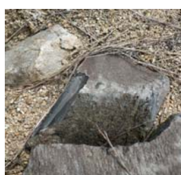
顔を出している石を金鎚で叩くとスパッと割れ、色黒々のリバーパターン状の平坦な破面が出た
