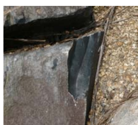
顔を出している石を金鎚で叩くとスパッと割れ、色黒々のリバーパターン状の平坦な破面が出た
