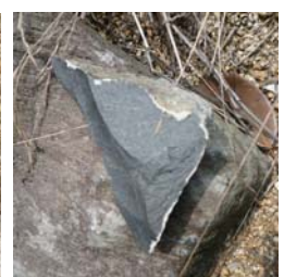
顔を出している石を金鎚で叩くとスパッと割れ、色黒々のリバーパターン状の平坦な破面が出た
