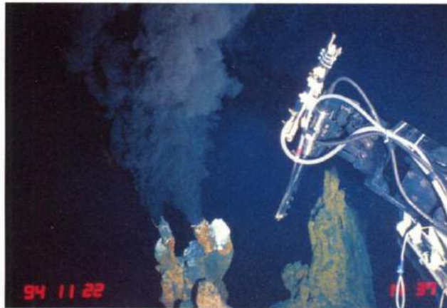
東太平洋海嶺の巨大ブラックスモーカーでマニピュレータで熱水を採取している様子。
