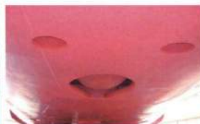
船底部の音波航法装置の送波器(手前の2つ)と水中通信機の格納式のソーナードーム
