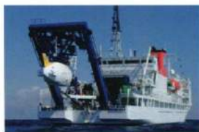
重さ約26トンの「しんかい6500」を吊り上げる巨大なAフレームクレーン
