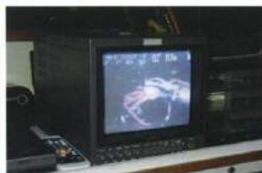
音波画像伝送装置により、「しんかい6500」のカメラがとらえた映像が静止画として船上に送られる
