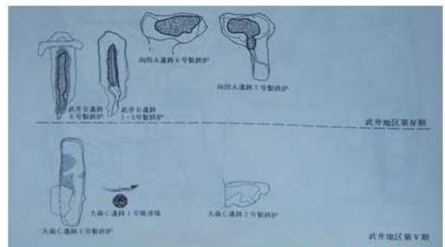
第Ⅳ期 踏み鑪付き箱型炉・竪型炉の並立 8世紀後半～9世紀初 第Ⅴ期 単独の踏み鑪のついた大型箱型炉の時代へ 9世紀中葉
