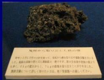
鬼板を製鉄原料として取り出した鉄塊
