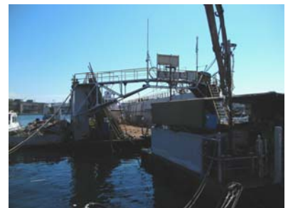
兵庫港 東出町の岸壁にある浮きドック ドックの一つにはアルミ船が入り 作業が行われていました
