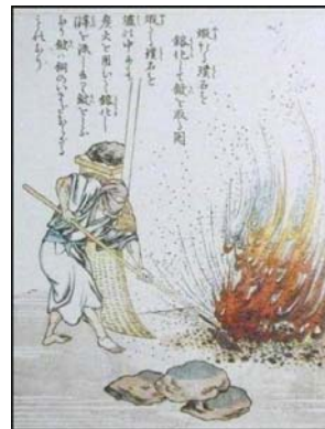
焼いた鉱石を火床で溶融し、鉄分と硫黄を飛ばして硫化銅が主成分のカワにする 別子銅山「鼓銅図録」より
