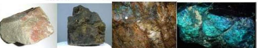
合銅硫化鉄鉱 黄銅鉱 黄銅鉱 斑銅鉱 硫化物鉱石
