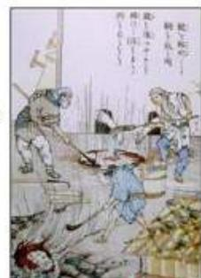
b. 酸化銅成分溶融と酸化脱硫「高吹る」
