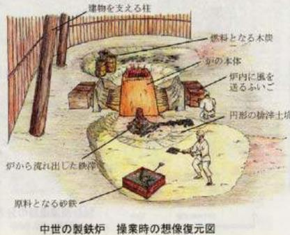
中世の製鉄炉 操業時の想像復元図
