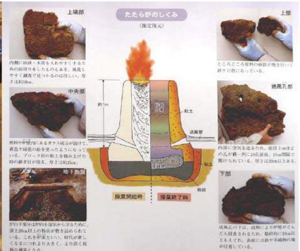
資料によるとここには 炉床を粘土貼りした鉄アレイ型の製鉄炉があり、保存状態の良い炉床と多数の炉壁片が見つかったので、中世の製鉄炉の状況が良く復元できるという。
