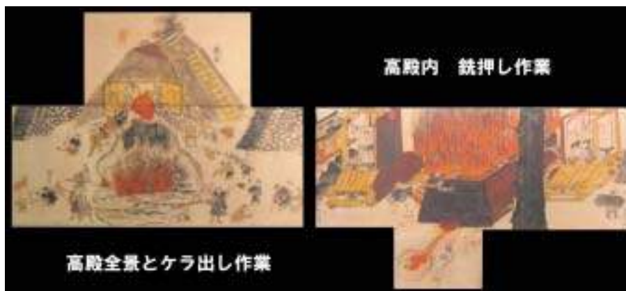
上巻部分 たたら製鉄の 主要な工程
