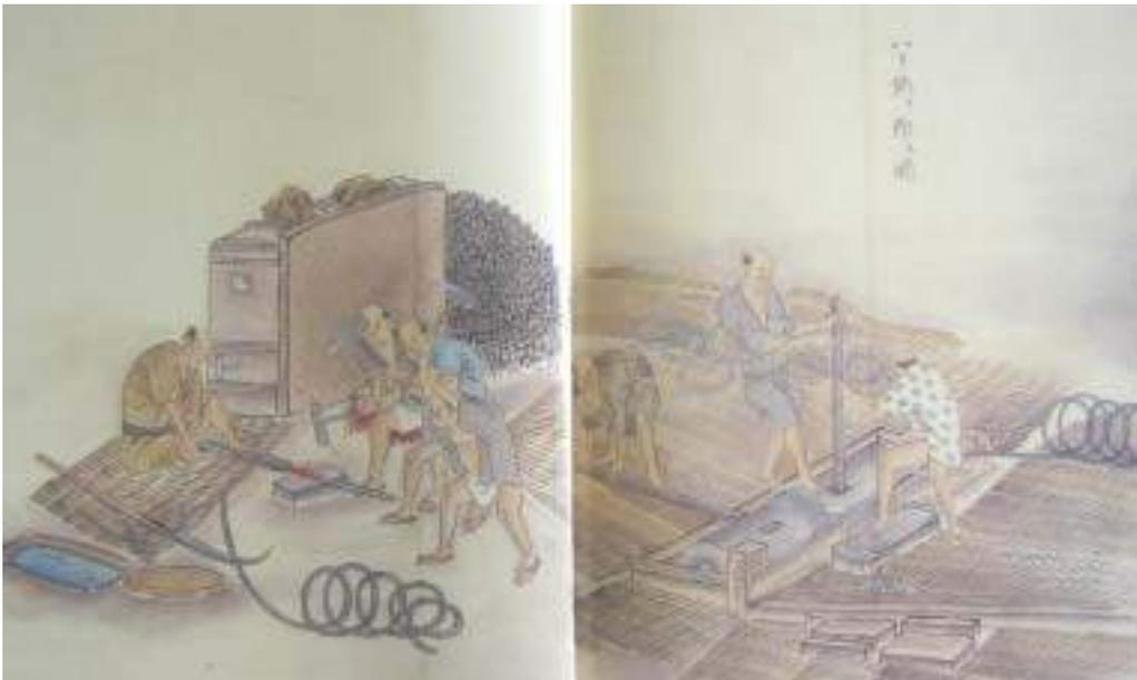
包丁鉄から熱間鍛造による線材作り、そして冷間ダイス線引きによる針金作りの様子が克明に描かれている。こんな江戸時代のダイス線引きの様子を見るのは初めてでビックリである。
