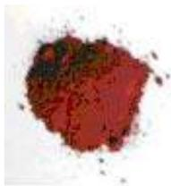
ベンガラ製造は吹屋で 江戸期宝永 4 年 (1707) 自然風化によってできる硫酸鉄 (ローハ・緑礬)を原料に始まったといわれ、宝暦年間(17501~1763)に硫化鉄鉱(磁硫鉄鉱)から人工的に硫酸鉄を凝結させる方法を発明して大量生産の道をつけ、全国一手製造販売の大繁栄をもたらした。
