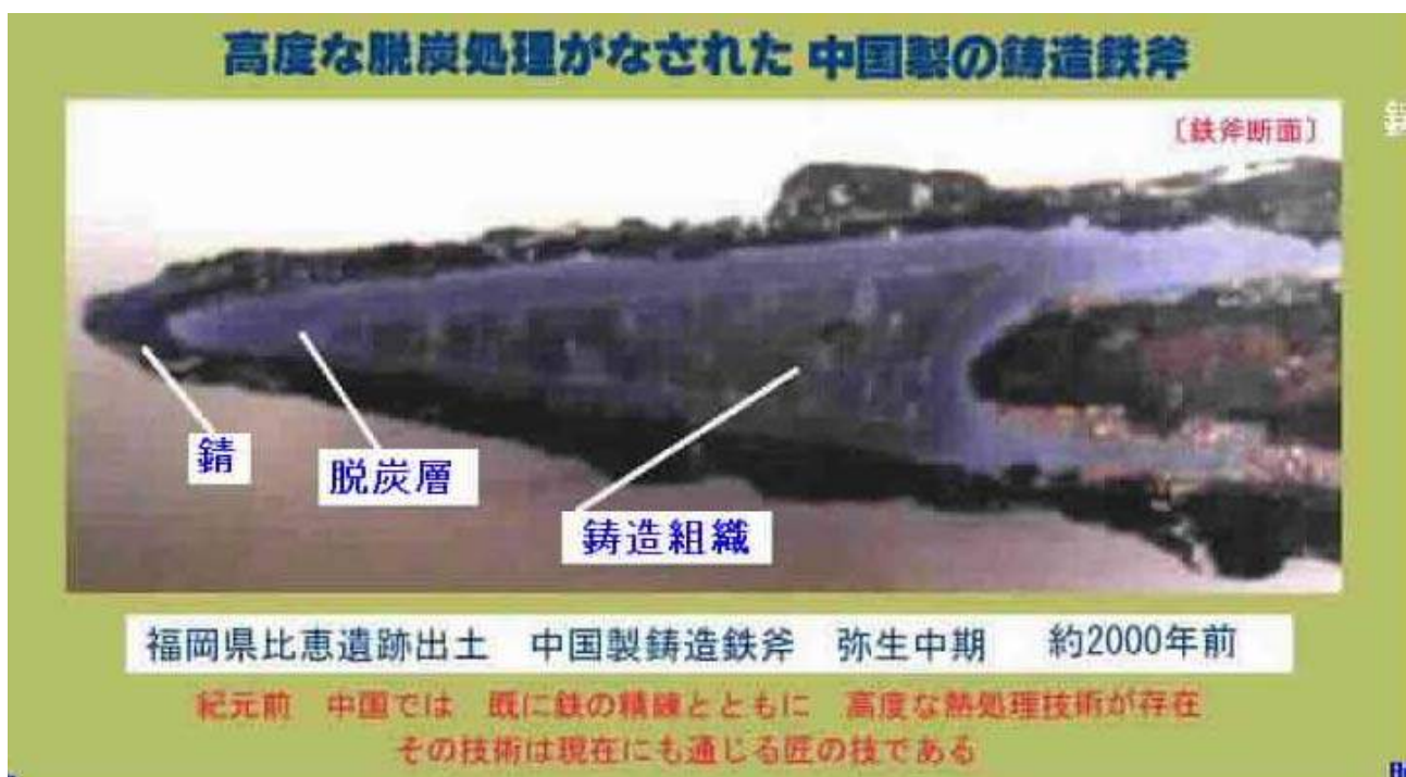
高度な熱処理による脱炭表面処理がなされた中国製の古代 鋳造鉄斧
