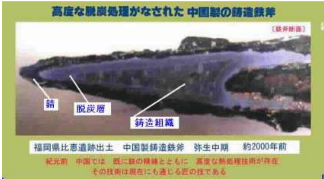
高度な熱処理による脱炭表面処理がなされた中国製の古代 鑄造鉄斧
