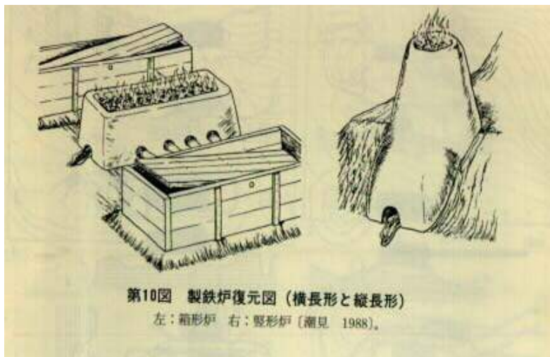
図 古代製鉄炉推定 箱型炉と竪型炉
