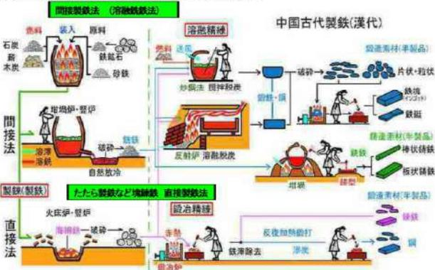
中国漢代後半には既に溶融鉄から鋼を作る間接製鉄法が実用されていた
