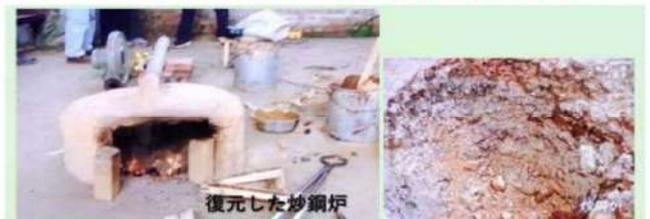
小さな炒鋼炉に炭素量の高い鑄鉄鉄塊を入れ、炉の上部から大量の酸素を吹き込みながら1200℃近傍に加熱すると鑄鉄鉄中の炭素が火花を上げつつ燃えて炭素量の低い強靱な鋼に替わってゆく。
