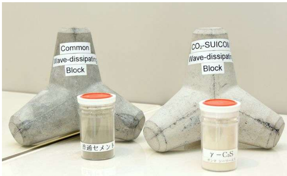
スイコムでつくった消波ブロック（右）と一般のコンクリート。 セメントの代わりに、デンカの \gamma -C 2 Sを使ったスイコムは、植物のようにCO 2 を吸収・固定する
