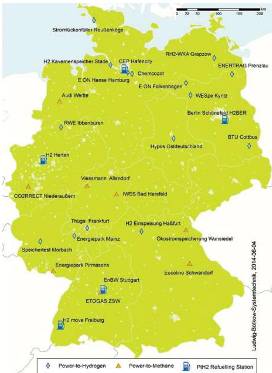
図 6-42 ドイツの Power-to-Gas プロジェクト (▲がメタン化プロジェクト)
