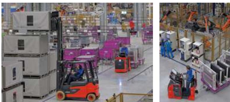
図6-64 BMWライプチッヒ工場での燃料電池フォークリフト実証実験「H2IntraDrive」
