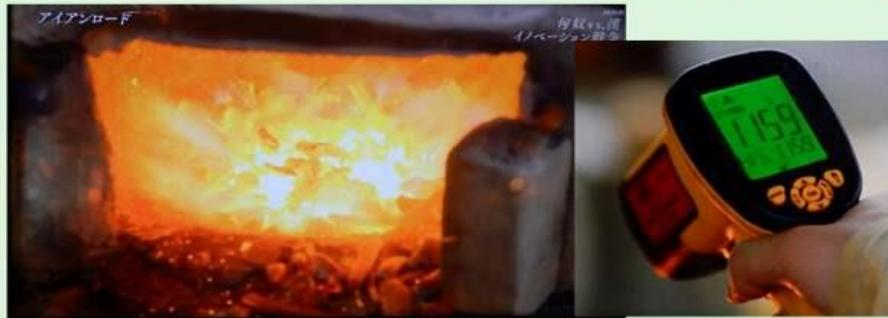
約1200℃の炒鋼炉で小割した脆い鑄鉄塊を酸素を吹き込みつつ熱処理
