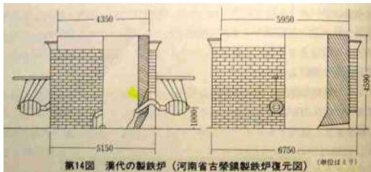
第14図 漢代の製鉄炉 (河南省古榮鎮製鉄炉復元図) (単位はミリ)
