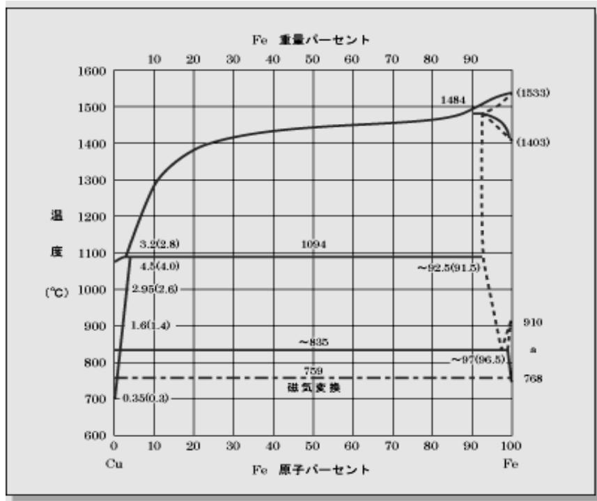
Cu-Fe<sub>2</sub>π 平衡状態図
