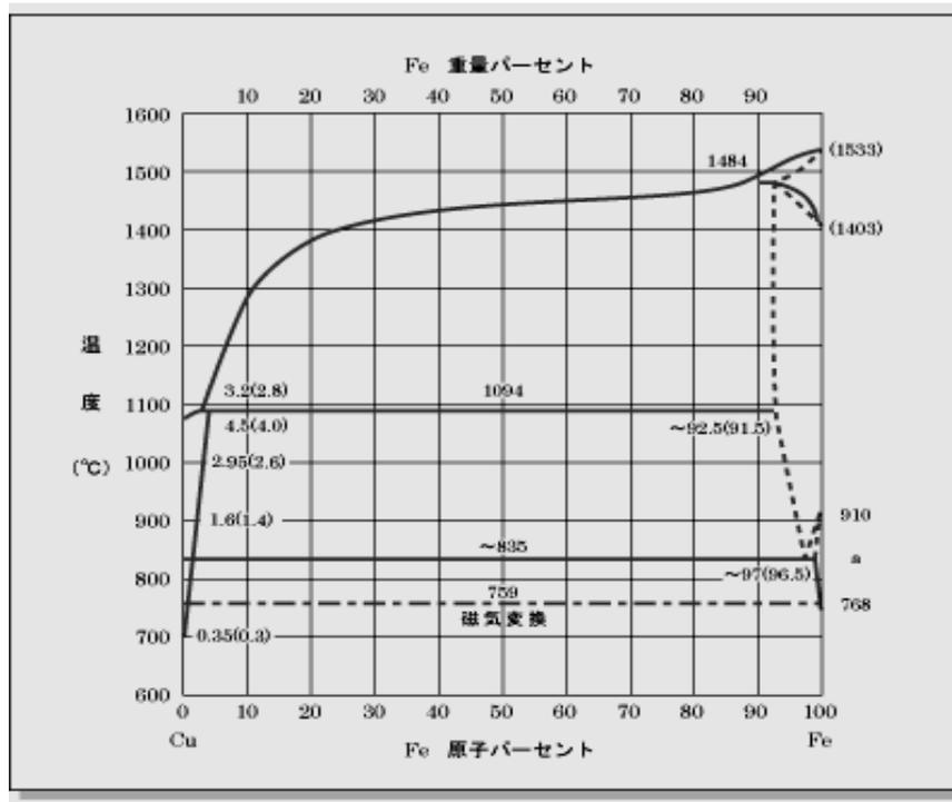
Cu-Fe<sub>2</sub>π 平衡状態図
