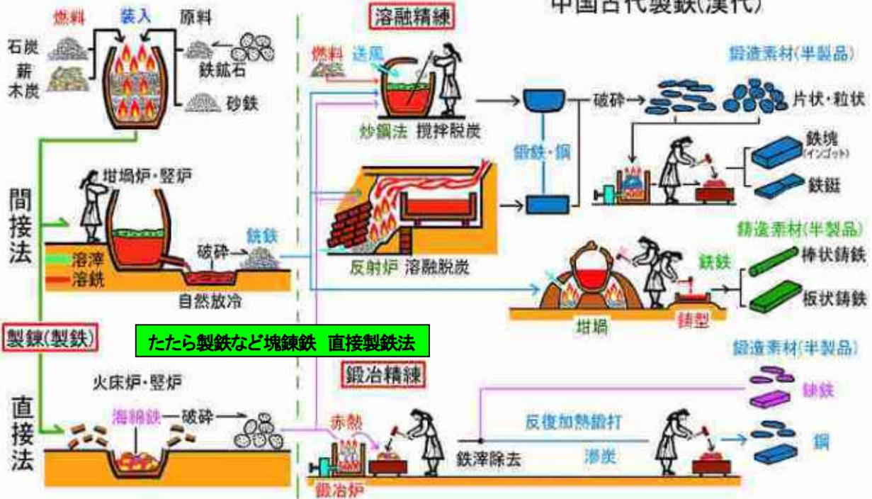
中国漢代後半には既に熔融銹鉄から鋼を作る間接製鉄法が実用されていた
