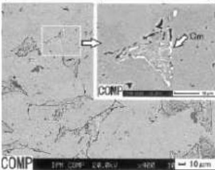
写真3 カマン・カレホユック遺跡第Ⅲc層出土No.1鉄片のEPMAによる組成像 (COMP)。Cmはセメントタイト (Fe<sub>3</sub>C)。写真右上は枠内部を拡大。
