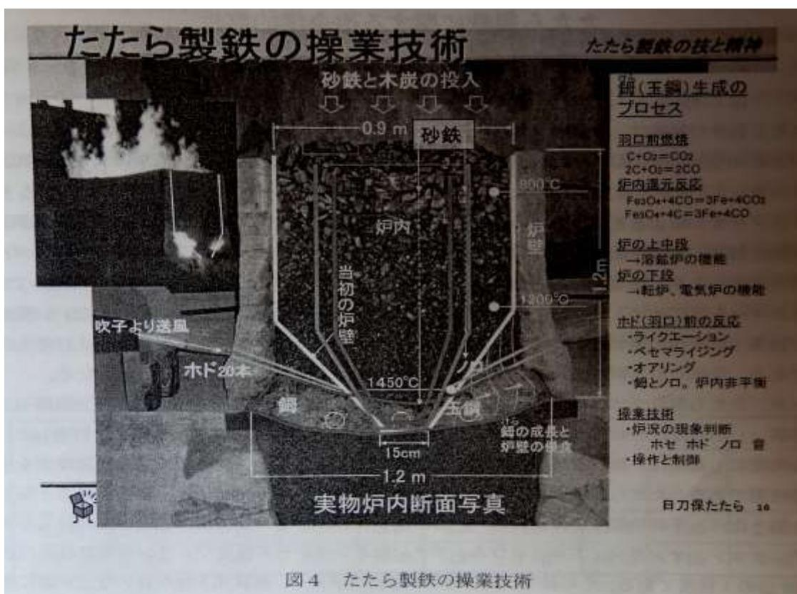
図4 たら製鉄の操業技術
