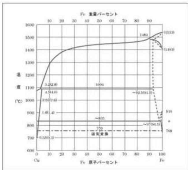
第1図 Cu-Fe2系 平衡状態図
