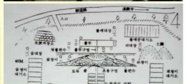
古代を引き継ぐ製鉄炉は 下部の炉底面周面に割石を積み積み、上部炉壁を積み際の支持帯を作って炉体を構築。送風は鞆。送風管は破片のしか出土していないが、厚さ約1cm 内径14~cm 程度の大口径送風管が、1・2本が炉壁外から差込まれ、高温操業による溶融痕跡が見られる。
