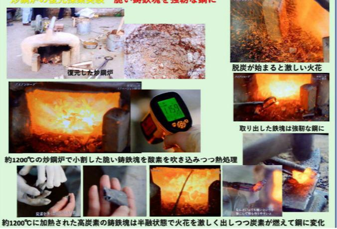
復元した高炉と炒鋼炉の復元操業実験
