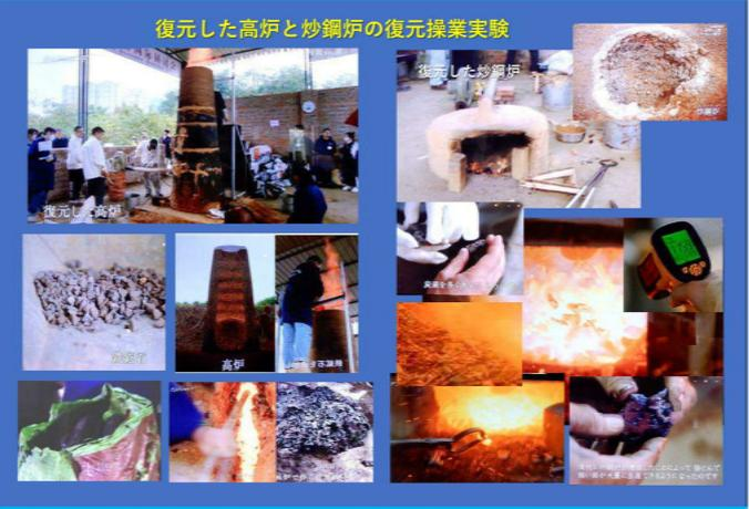
鉄の巨大国家 中国 鉄のイノベーション【2】脆い鑄鉄を強靱な鋼にかえる炒鋼法
