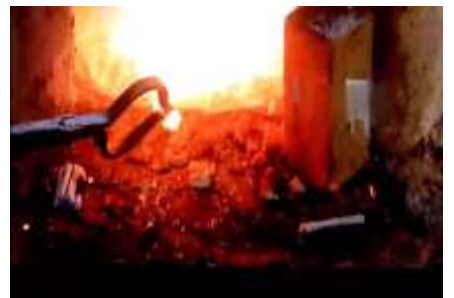
炒鋼炉 鑄鉄鉄の脱炭プロセス 激しく火花を飛ばし炭素が燃え、温度が落ち
