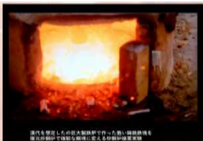
現代を想定したの巨大製鉄炉で作った脆い鑄鉄鉄塊を復元炒鋼炉で強靱な鋼塊に変える炒鋼炉調査実験
