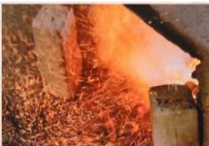
現代を想定したの巨大製鉄炉で作った脆い鑄鉄鉄塊を復元炒鋼炉で強靱な鋼塊に変える炒鋼炉調査実験
