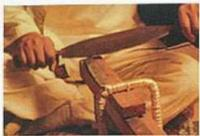
11 刀身を一樣に加熱(約八〇〇度)したものを水槽に入れて急冷する。日本刀の反りにこのときに加わる。「焼き入れ」。
