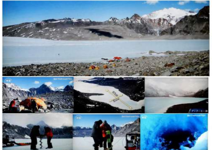
ドリルで穴をあけ、湯水を船み上げ、再度船に戻すことで、穴の壁を温め、穴を広げる。湯水で穴を作るのも一苦労である
