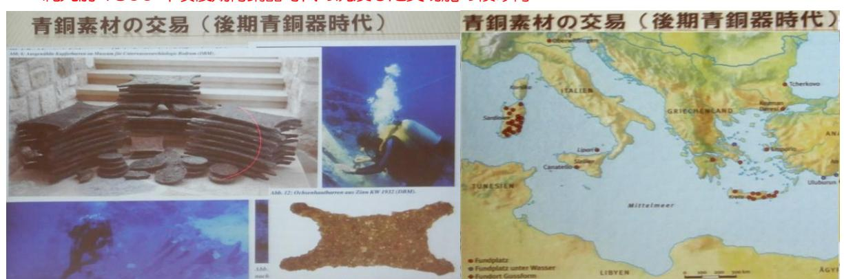
銅 10t: 牛皮インゴット348個/1個平均27~28kg 円盤インゴット121個
