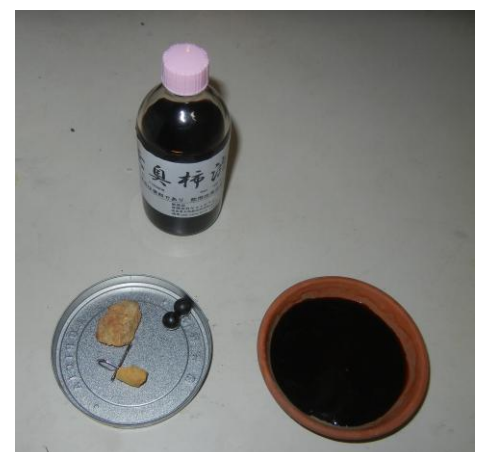
赤さびが発生している鉄鋏の右側半分だけ柿渋を塗り、何回か塗り重ね実験の結果
