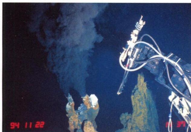
東太平洋海嶺の巨大ブラックスマーカーでマニピュレーターで热水を採取している様子。
