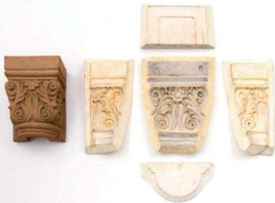
一橋大学兼松濤堂柱頭テラコッタおよび型枠（昭和58年現元、INAXライブミュージアム蔵）
