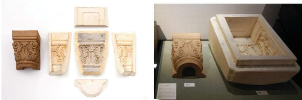
一橋大学兼松講堂柱頭テラコッタおよび型枠(昭和58年復元、INAXライブミュージアム蔵)
