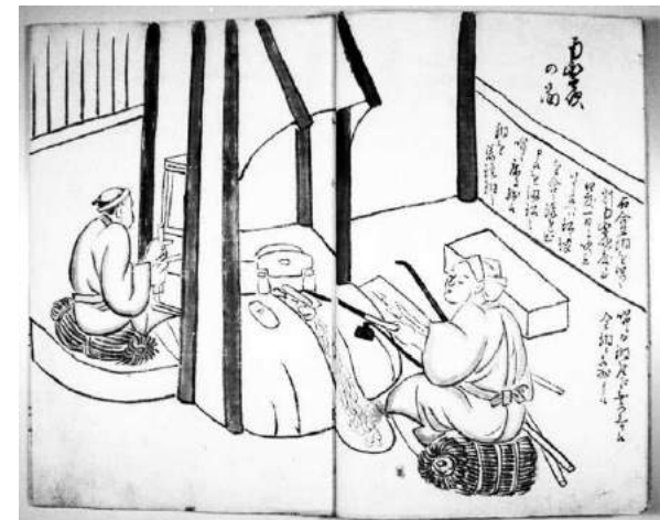
「摂州多田銀銅山鉛石吹立次第荒増」に記された「南蛮吹」の工程(猪名川町教育委員会提供)
