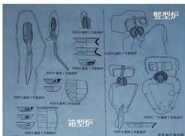
第Ⅲ期 箱型炉と踏み鑪のついた堅型炉出現の時代 8世紀中葉
