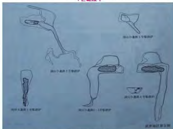
第Ⅱ期 斜面置き 片側に排滓する箱型炉の時代 8世紀前半
