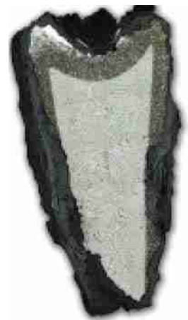
写真③ 鑄造鉄斧の断面 (銀色に輝く鉄の周囲にみられる黒灰色の膜状の部分が脱炭層・青谷上寺地遺跡)
