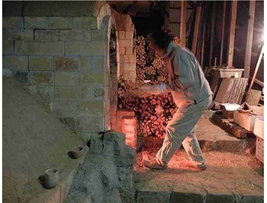
一の窯の窯焼き 火力の強い薪の投げ入れで さらに高温へ焼き上げる
