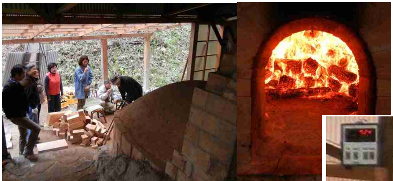
登り窯の窯焚き 登り窯の大口焚口に材木端が次々と投げ込まれ、窯の温度があげられてゆく 2011.1.15.
