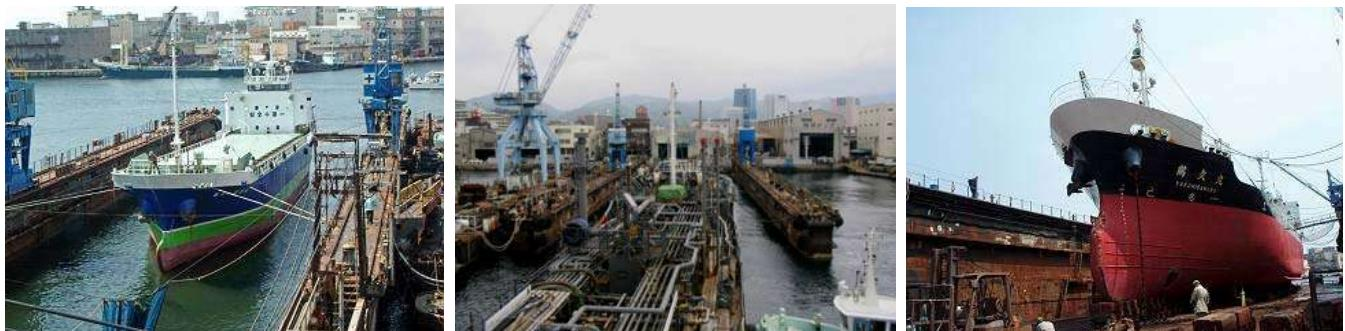
鋼鉄製の大きな箱の形をしている箱舟の一種。内部に水を入れて自らを半水没させ、船を中に入れたのち、排水して再び浮き上がらせ、船の修理・改装などを行なう。
