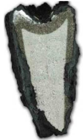
写真③ 鑄造鉄斧の断面
