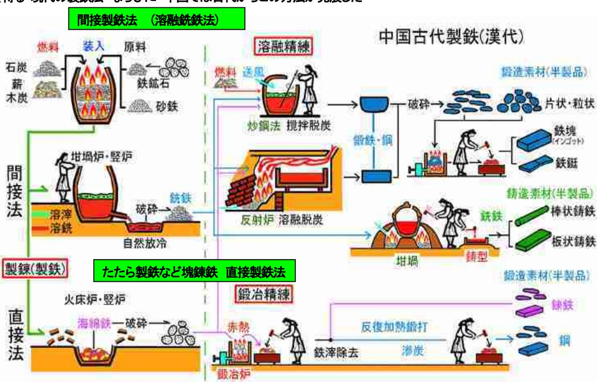
中国漢代後半には既に溶融銑鉄から鋼を作る間接製鉄法が実用されていた
