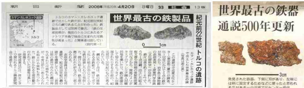
「ヒッタイトの鉄」 鉄鉱石を炭と一緒に直接加熱 半溶融状態で還元して「鋼」を作る塊鍊鉄法
