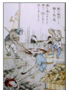
b. 硫化銅成分を溶融と酸化脱硫「高吹き」 図の中央に空気吹付け口が見える
