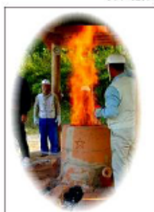
聖門宮印による還元製錬 原料鉱石は白土銅・酸化銅系銅鉱石 古代 銅製錬 還元製錬の図（京都）
