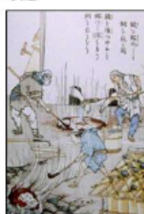
⇒ 硫化銅成分溶解と酸化銅「灰吹き」 回の中中央に空気吹き羽口が見える 江戸期の銅製錬技術（別子銅山）
