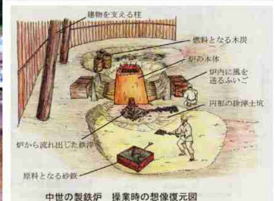
中世の製鉄炉 作業時の想像復元図 建物内部は幅 12m 奥行き 7m 以上 床面積 80 m 2 以上 現存する菅谷たたら約 1/4
