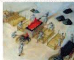
炉の大きさ 約1.2m × 約2mの箱型炉
