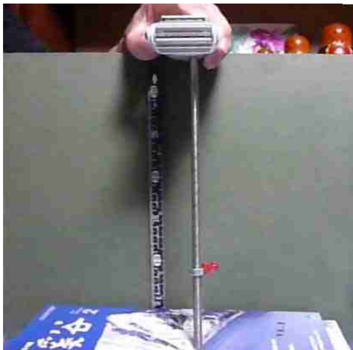
[イブレーターで ボルトの頭を振動させるとナットは廻る]
