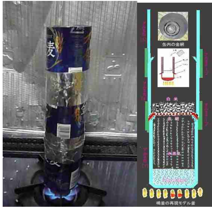
アルミ缶で製作した「鳴釜」モデル釜
