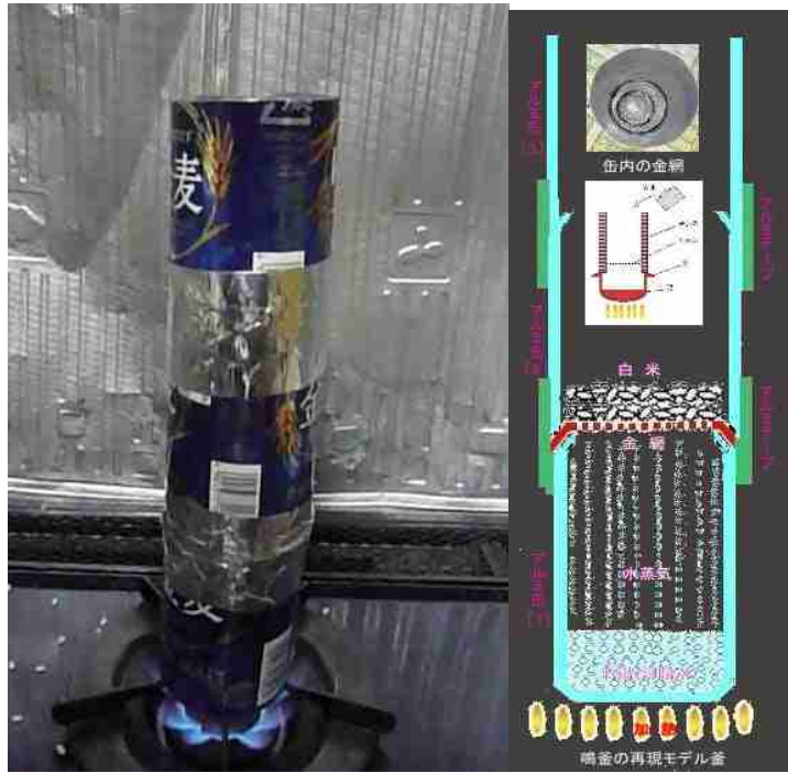
アルミ缶で製作した「鳴釜」モデル釜
