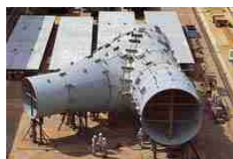
水圧鉄管の例 地下埋設管&ペンストック分岐部 と水圧鉄管用極厚板の溶接継手試験片
