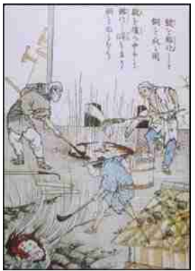
カワを再度溶融 硫黄を飛ばして荒銅を作る
